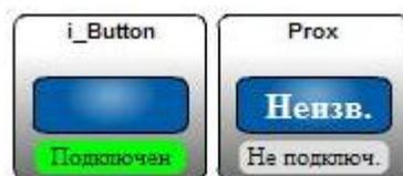
Датчик i-Button подключен, датчик Proximity не подключен к шине SoliBus.
