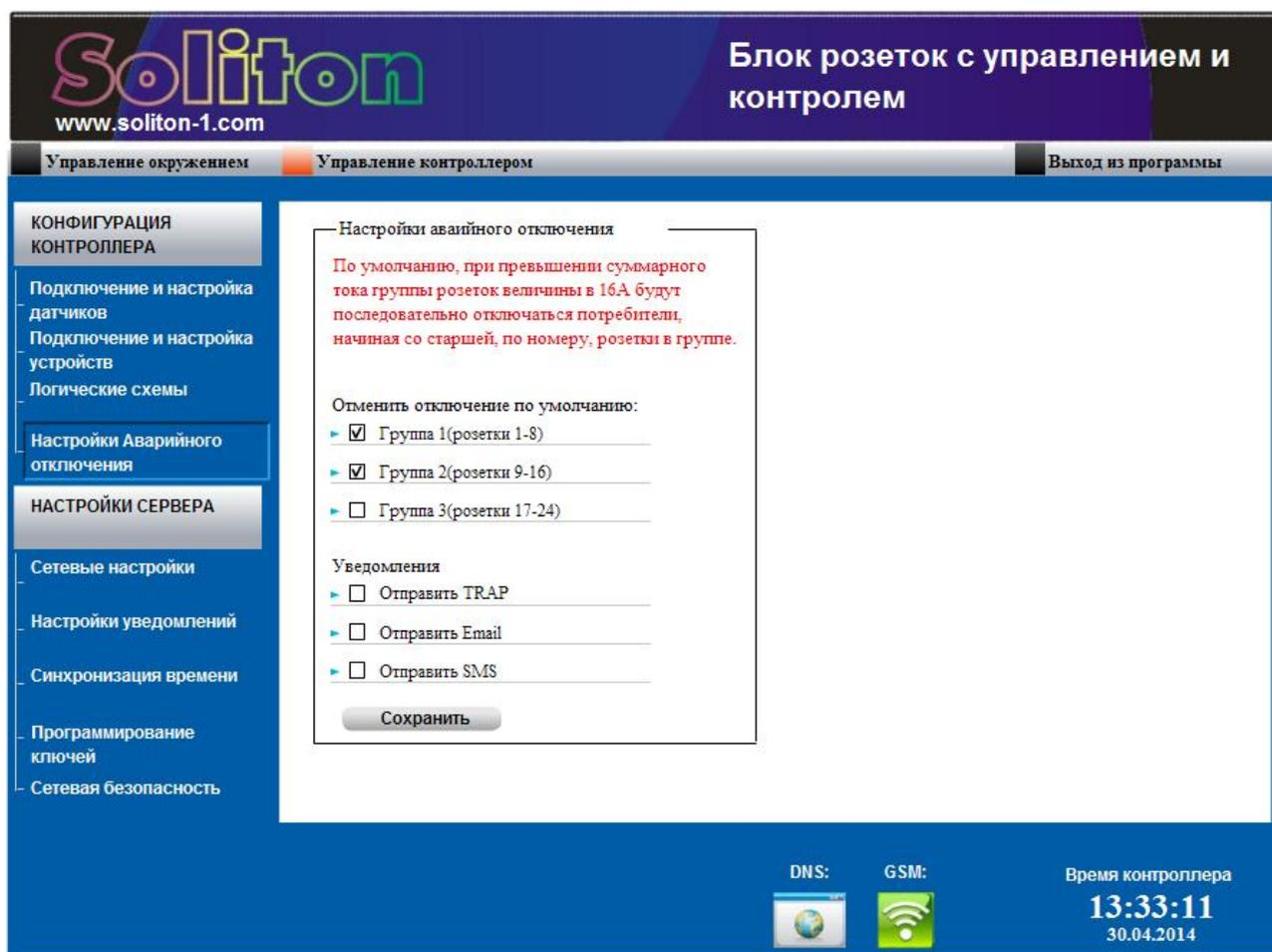
В зависимости от исполнения, управляемый блок может содержать до 24 розеток, разбитых по подключению на секции по 8 розеток.
