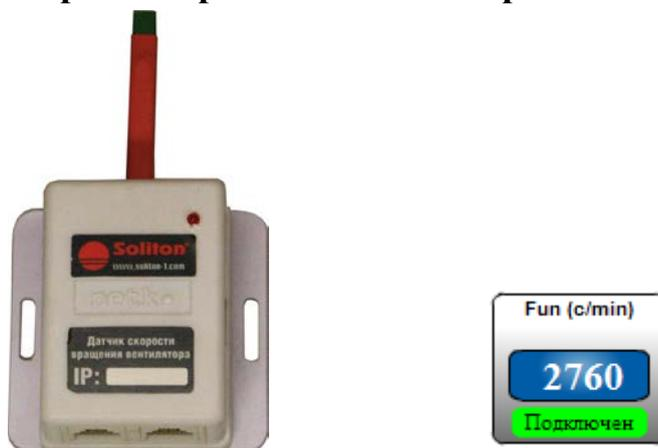
**Внешний вид датчика скорости вращения вентилятора и его отображение в окне управления контроллером.**
