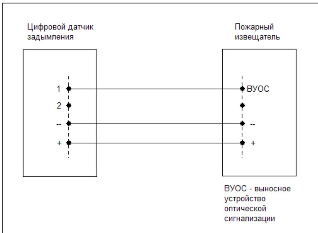
**Схема подключения пожарного извещателя к датчику задымления.**
